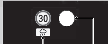
Señal de límite de velocidad en función de las condiciones* 2 Señal de límite de velocidad
