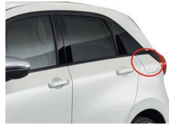
Tapón de llenado de combustible
