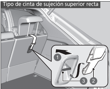
Tipo de cinta de sujeción superior recta 1 Parte delantera del vehículo 2 Gancho de la cinta de sujeción 3 Anclaje
